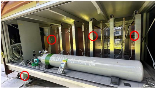
図3 温度計の端子の設置場所
